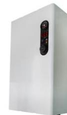
**Котел тэновый настенного размещения с циркуляционным 3х скоростным насосом и группой гидравлической безопасности (термоманометр, аварийный клапан Збар, автоматический воздухобросник) серии Classic MG (WCSMG), резьбовые присоединения 3/4 дюйма, нижнее подключение к системе отопления**
